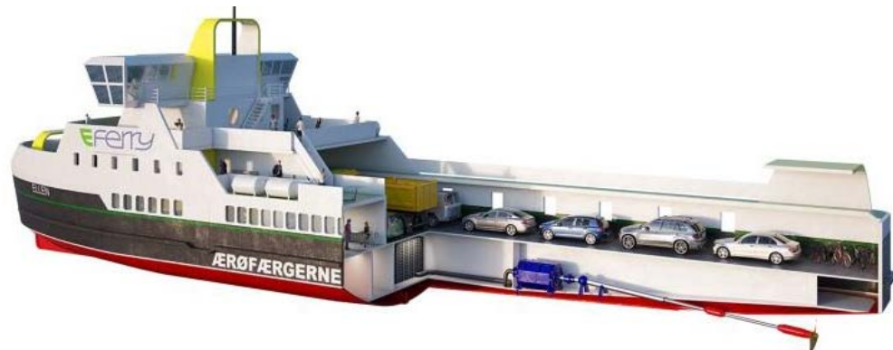
Fig. 8 Elfærgen på Ærø er den første færge, der er i stand til at sejle 22 sømil udelukkende på elektricitet.* Illustration: Jens Kristensen Consulting Naval Architects.
