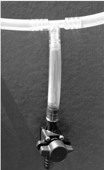
Abbildung 47 Ablassventil für überschüssiges Kondensat
